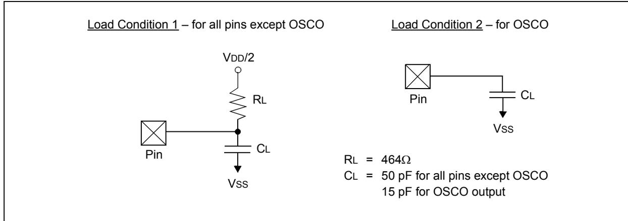
**TABLE 28-12: CAPACITIVE LOADING REQUIREMENTS ON OUTPUT PINS**
