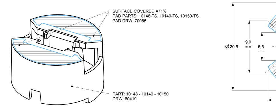
NOTES: -TAPE SPEC: 3M 9495LE -THICKNESS 0.17mm -GENERAL OFFSET FROM HOLDER EDGES IS 0.2mm
