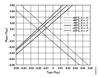
Figure 13. Z (W) Offset Over Temperature
