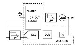
Figure 23. Fractional-Divider Loop
