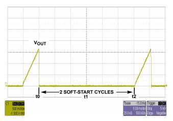
FIGURE 5. OVERCURRENT RETRY OPERATION
