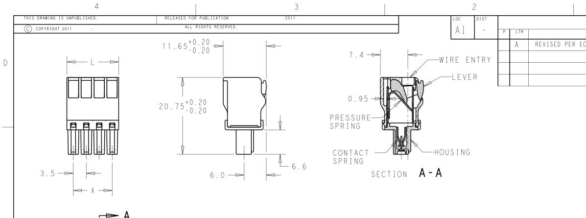
MATERIALS HOUSING-POLYAMIDE, COLOR-GREEN LEVER-POLYAMIDE, COLOR ORANGE CONTACT SPRING-COPPER ALLOY-LEAD FREE TIN PLATED CLAMPING SPRING-STEEL
