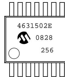
16-Lead QFN (MCP4631, MCP4651)
