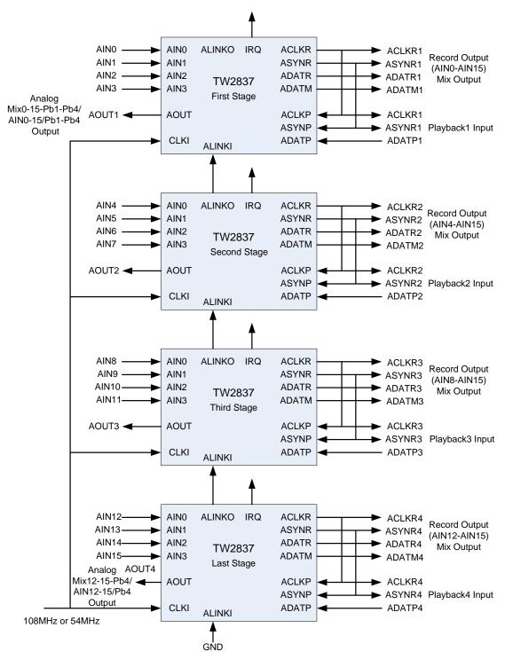
FIGURE 70 CONNECTION FOR MASTER MULTI-CHIP OPERATION ON ALINK CASCADE MODE
