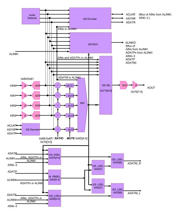
FIGURE 69 BLOCK DIAGRAM OF AUDIO CODEC
