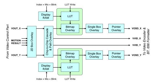
**FIGURE 52 OVERLAY BLOCK DIAGRAM**
