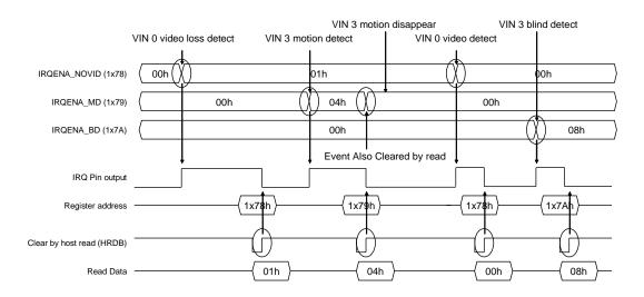
FIGURE 80 THE ILLUSTRATION OF INTERRUPT SEQUENCE
