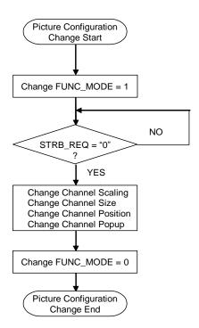
FIGURE 20 THE SEQUENCE TO CHANGE PICTURE CONFIGURATION
