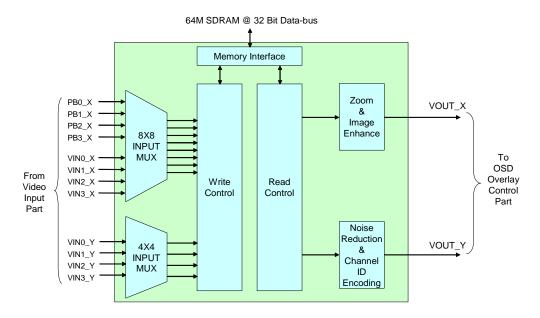
FIGURE 18 BLOCK DIAGRAM OF VIDEO CONTROLLER
