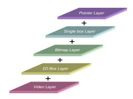
FIGURE 53 THE OVERLAY PRIORITY OF OSD LAYER
