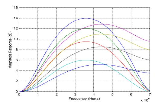
FIGURE 7 THE CHARACTERISTIC OF LUMINANCE PEAKING FILTER
