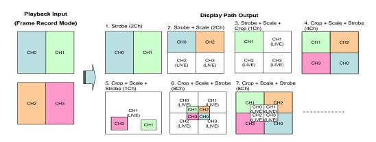
FIGURE 32 THE EXAMPLES OF THE PLAYBACK FUNCTION FOR FRAME RECORD MODE
