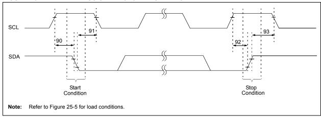
TABLE 25-18: I<sup>2</sup>C™ BUS START/STOP BITS REQUIREMENTS (SLAVE MODE)
