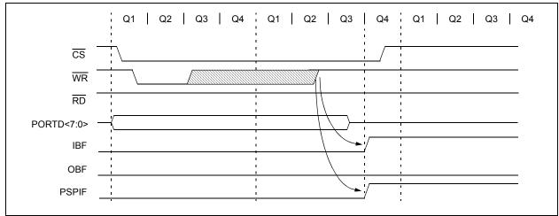
FIGURE 9-4: PARALLEL SLAVE PORT READ WAVEFORMS
