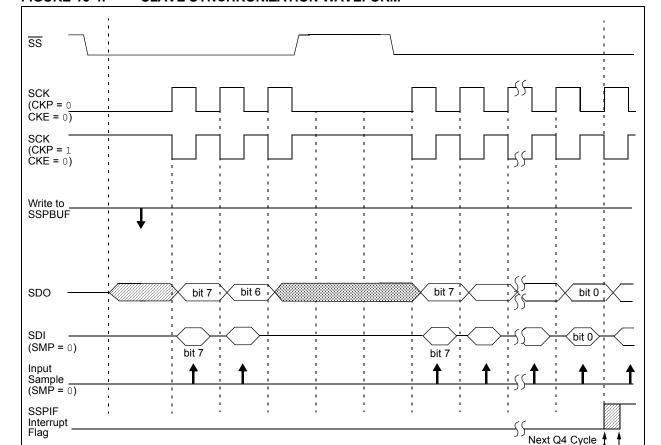
FIGURE 16-4: SLAVE SYNCHRONIZATION WAVEFORM
