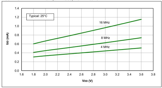
FIGURE 28-18: IDD MAXIMUM, HFINTOSC, PIC12LF1501 ONLY
