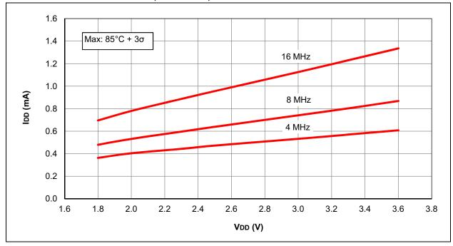
FIGURE 28-19: IDD TYPICAL, HFINTOSC, PIC12F1501 ONLY
