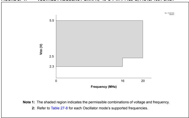
FIGURE 27-2: VOLTAGE FREQUENCY GRAPH, -40°C ≤ TA ≤ +125°C, PIC12LF1501 ONLY
