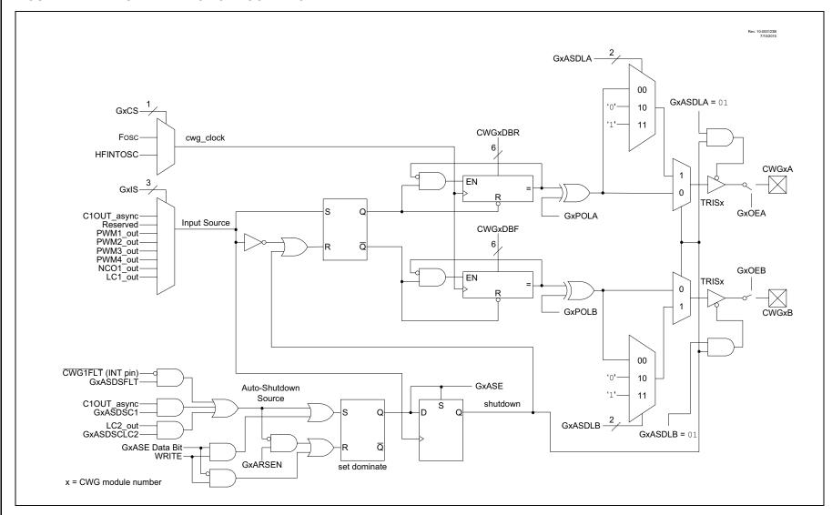
FIGURE 24-2: TYPICAL CWG OPERATION WITH PWM1 (NO AUTO-SHUTDOWN)
