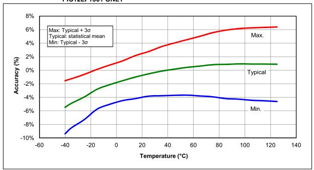
FIGURE 28-61: HFINTOSC ACCURACY OVER TEMPERATURE, 2.3V \( \le \) VDD \( \le \) 5.5V
