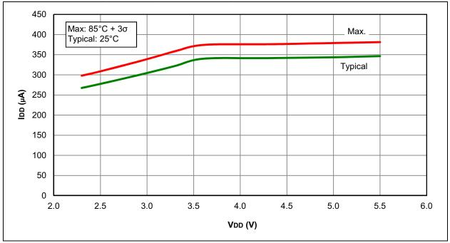
FIGURE 28-17: IDD TYPICAL, HFINTOSC, PIC12LF1501 ONLY
