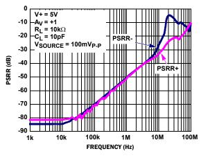
FIGURE 9. PSRR vs FREQUENCY
