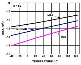
FIGURE 22. I<sub>BIAS+</sub> vs TEMPERATURE V<sub>S</sub> =  $\pm 2.5V$
