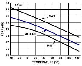
FIGURE 26. PSRR vs TEMPERATURE ±1.5V TO ±2.5V
