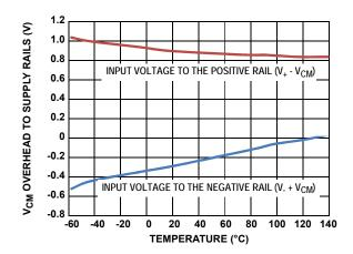
FIGURE 29. INPUT COMMON MODE VOLTAGE vs TEMPERATURE
