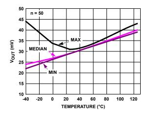
FIGURE 28. NEGATIVE V<sub>OUT</sub> vs TEMPERATURE R<sub>L</sub> = 1k, V<sub>S</sub> =  $\pm 2.5$ V
