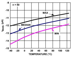
FIGURE 23. I<sub>BIAS-</sub> vs TEMPERATURE V<sub>S</sub> =  $\pm 2.5V$
