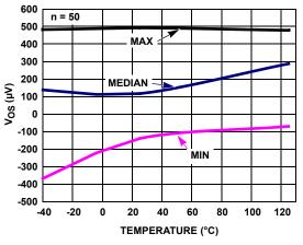
FIGURE 21.  $V_{OS}$  vs TEMPERATURE  $V_S$  = ±2.5V
