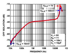
FIGURE 10. OFF ISOLATION vs FREQUENCY
