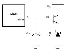
Figure 30. External 3.7-V Soft-Start Clamp
