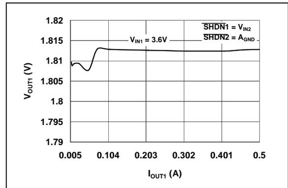
**FIGURE 2-12:**  $V_{OUT1}$  vs.  $I_{OUT1}$  ( $V_{OUT1} = 1.8V$ ).
