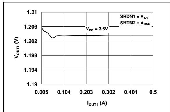
**FIGURE 2-11:**  $V_{OUT1}$  vs.  $I_{OUT1}$  ( $V_{OUT1} = 1.2V$ ).
