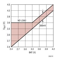
Figure 1. V<sub>OUT</sub> vs BAT
