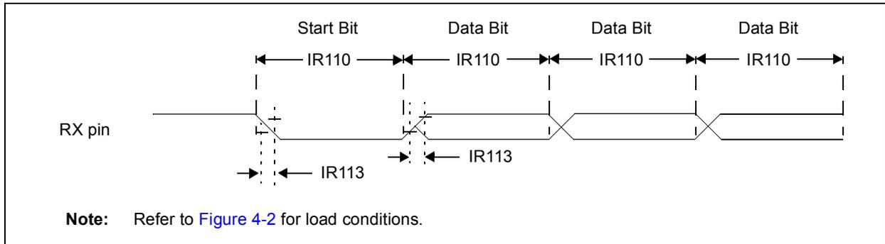
**TABLE 4-7: UART ASYNCHRONOUS RECEIVE REQUIREMENTS**
