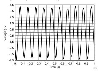
Figure 75. ADS1299 10-Hz Input Signal Results
