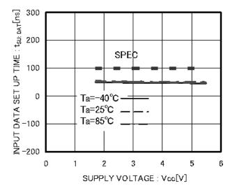
Figure 19. Input Data Setup Time tSU:DAT(HIGH)
