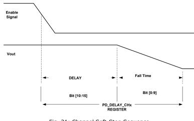
Fig. 21: Channel Soft-Stop Sequence
