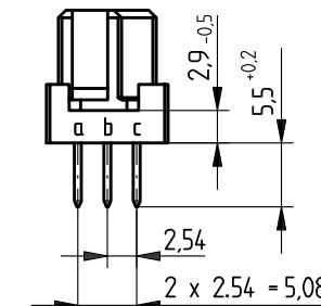
Elastische Einpresszone / compliant pressfit zone
