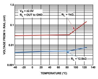
FIGURE 20.  $V_{OL}$  vs TEMPERATURE
