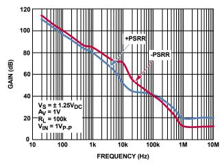
FIGURE 37. PSRR vs FREQUENCY, V<sub>S</sub> = 2.5V
