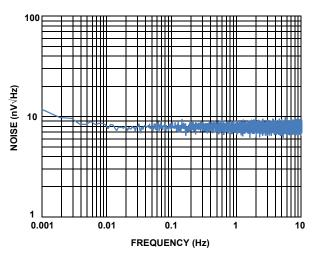
FIGURE 21. INPUT NOISE VOLTAGE DENSITY vs FREQUENCY
