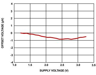
FIGURE 10. V<sub>OS</sub> vs SUPPLY VOLTAGE
