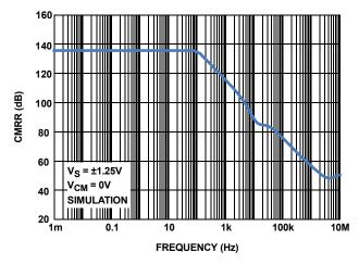
FIGURE 35. CMRR vs FREQUENCY, V<sub>S</sub> = 2.5V
