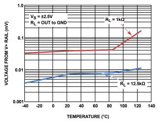
FIGURE 19. V<sub>OH</sub> vs TEMPERATURE
