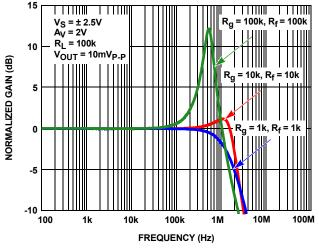
FIGURE 29. GAIN vs FREQUENCY vs FEEDBACK RESISTOR VALUES  $R_{\rm f}/R_{\rm g}$
