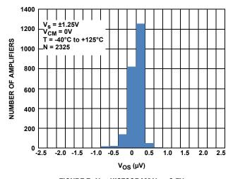
FIGURE 7.  $V_{OS}$  HISTOGRAM  $V_S = 2.5V$
