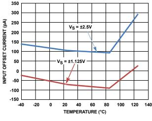
FIGURE 14. I<sub>OS</sub> vs TEMPERATURE
