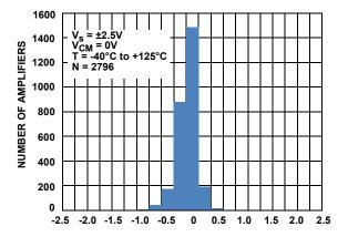
FIGURE 2. V<sub>OS</sub> HISTOGRAM V<sub>S</sub> = 5V
