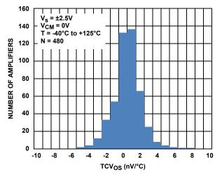
FIGURE 6. TCV<sub>OS</sub> HISTOGRAM  $V_S = 5V$
