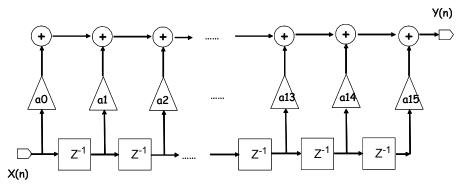
$y(n) = a0.x(n) + a1.x(n-1) + a2.x(n-2) + a3.x(n-3) + a4.x(n-4) + a5.x(n-5) + a6.x(n-6) + a7.x(n-7) \\ + a8.x(n-8) + a9.x(n-9) + a10.x(n-10) + a11.x(n-11) + a12.x(n-12) + a13.x(n-13) + a14.x(n-14) + a15.x(n-15)$
