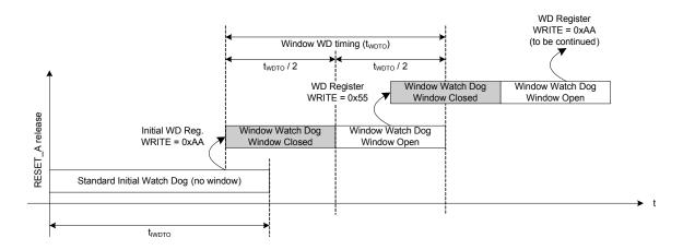
Figure 39. MM912\_637 Analog die watchdog operation
