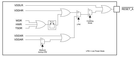
Figure 27. Analog die reset implementation
