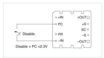
Figure 2 — Module enable/disable
