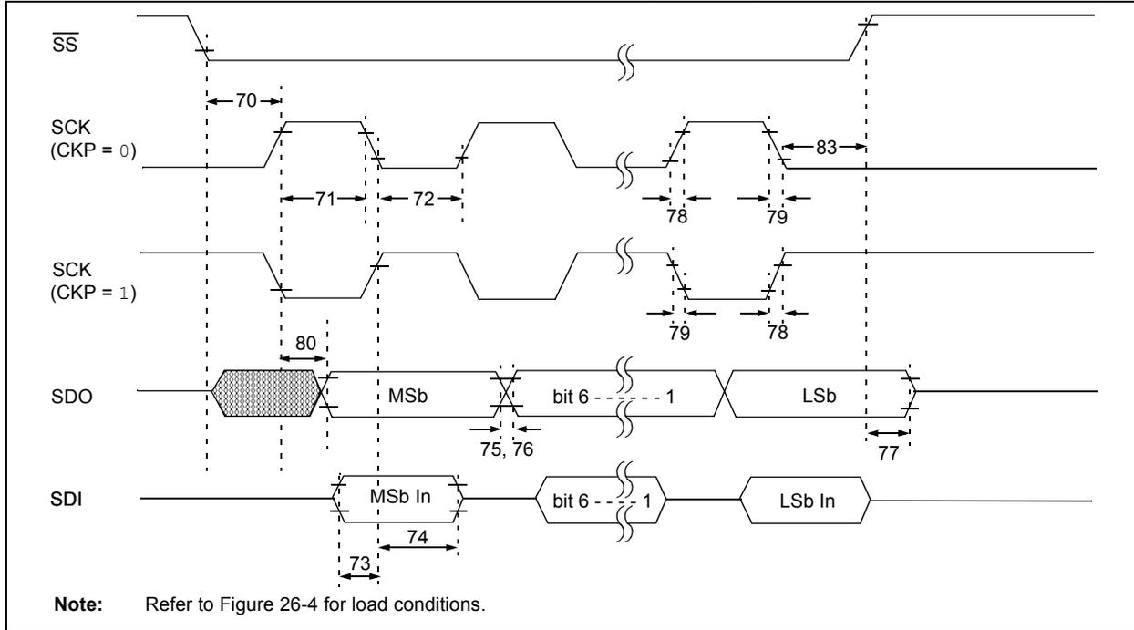
**TABLE 26-15: EXAMPLE SPI MODE REQUIREMENTS (SLAVE MODE TIMING, CKE = 0)**
