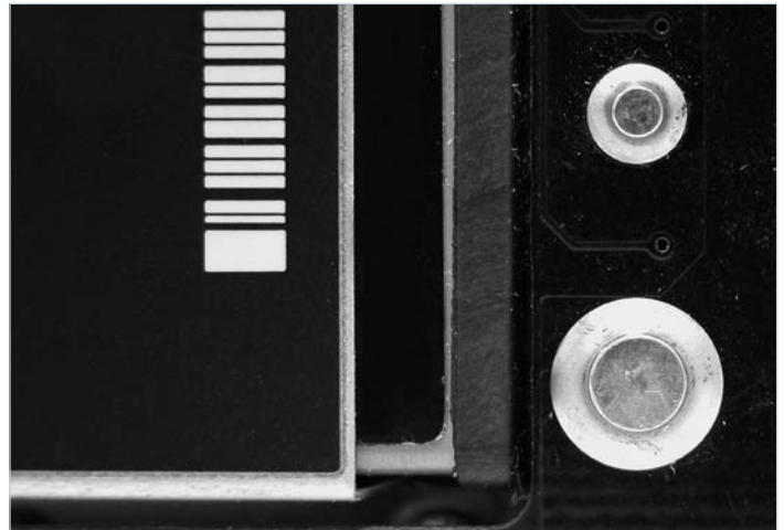
Figure 23.2 — Maxi / Mini output power pin and Sense pin
