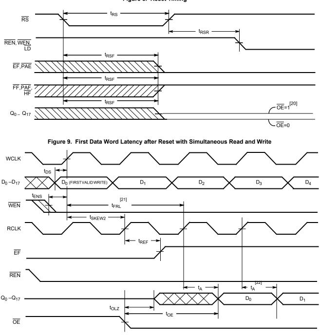
Figure 8. Reset Timing <sup>[19]</sup>
