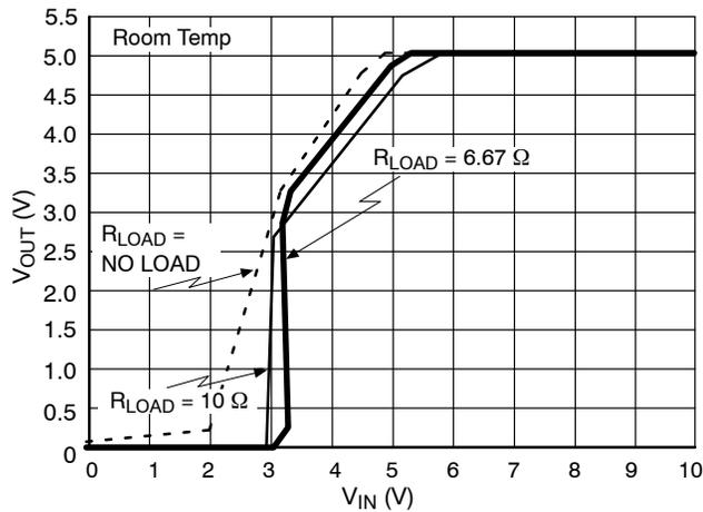
Figure 5. V<sub>OUT</sub> vs. V<sub>IN</sub> Over R<sub>LOAD</sub>
