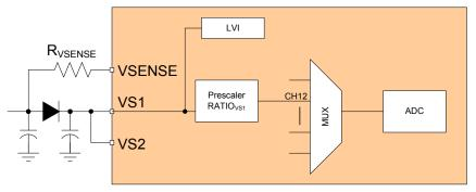
Figure 42. VS1Sense Module
