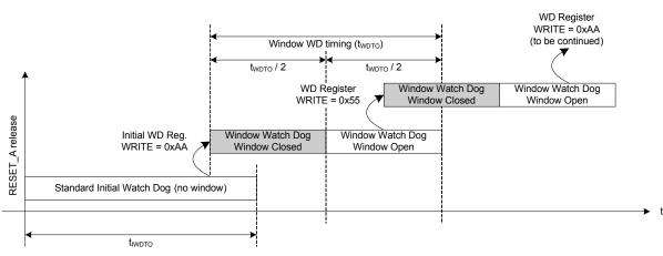
Figure 20. MM912\_634 Analog Die Watchdog Operation
