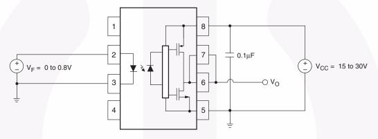
Figure 27. V<sub>FHL</sub> Test Circuit
