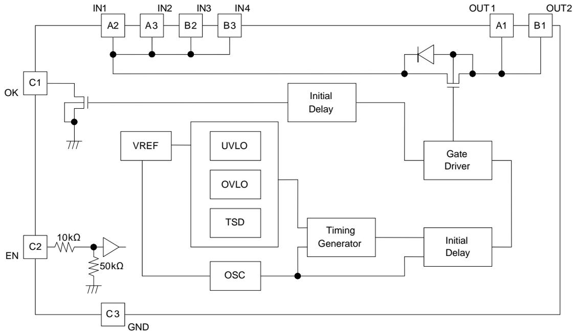
Fig. 13 Block Diagram
