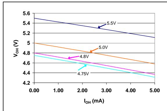
**FIGURE 2-22:**  $V_{OH}$  vs.  $I_{OH}$
