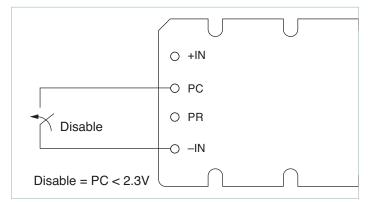
Figure 2 — Module enable/disable
