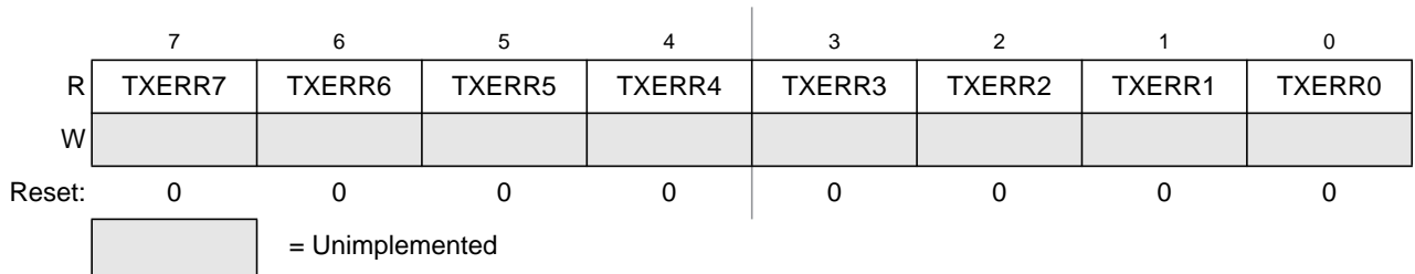
Figure 8-19. MSCAN Transmit Error Counter (CANTXERR)
