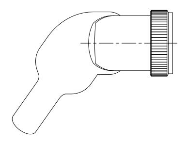
SPIN-LOCK ADAPTER, HEAT SHRINKABLE MOLDED PART, SEALED
