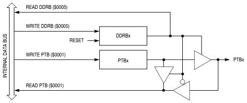
Figure 12-8. Port B I/O Circuit
