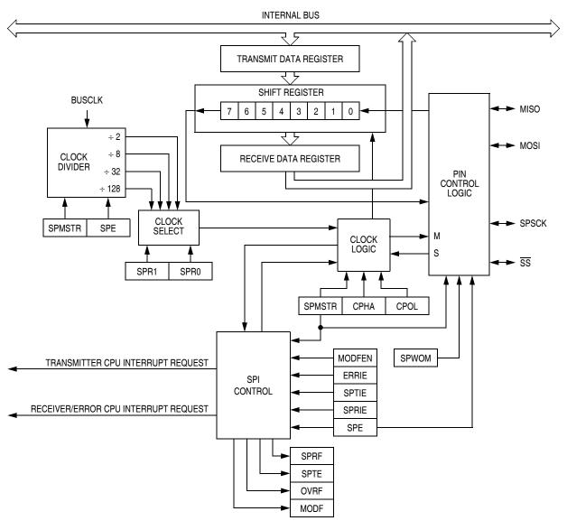
Figure 15-2. SPI Module Block Diagram
