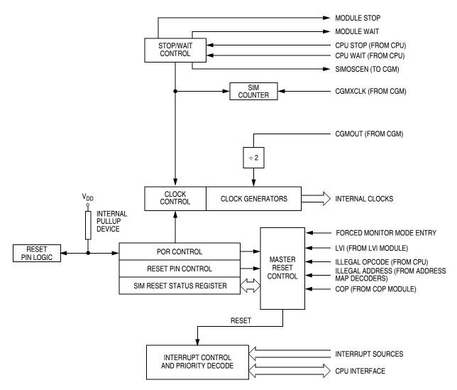
Figure 14-1. SIM Block Diagram
