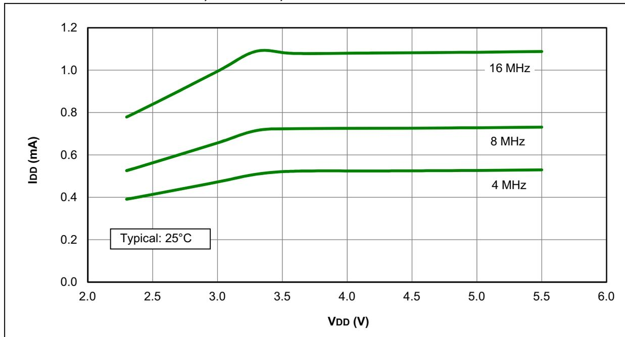
FIGURE 28-20: I<sub>DD</sub> MAXIMUM, HFINTOSC, PIC12F1501 ONLY
