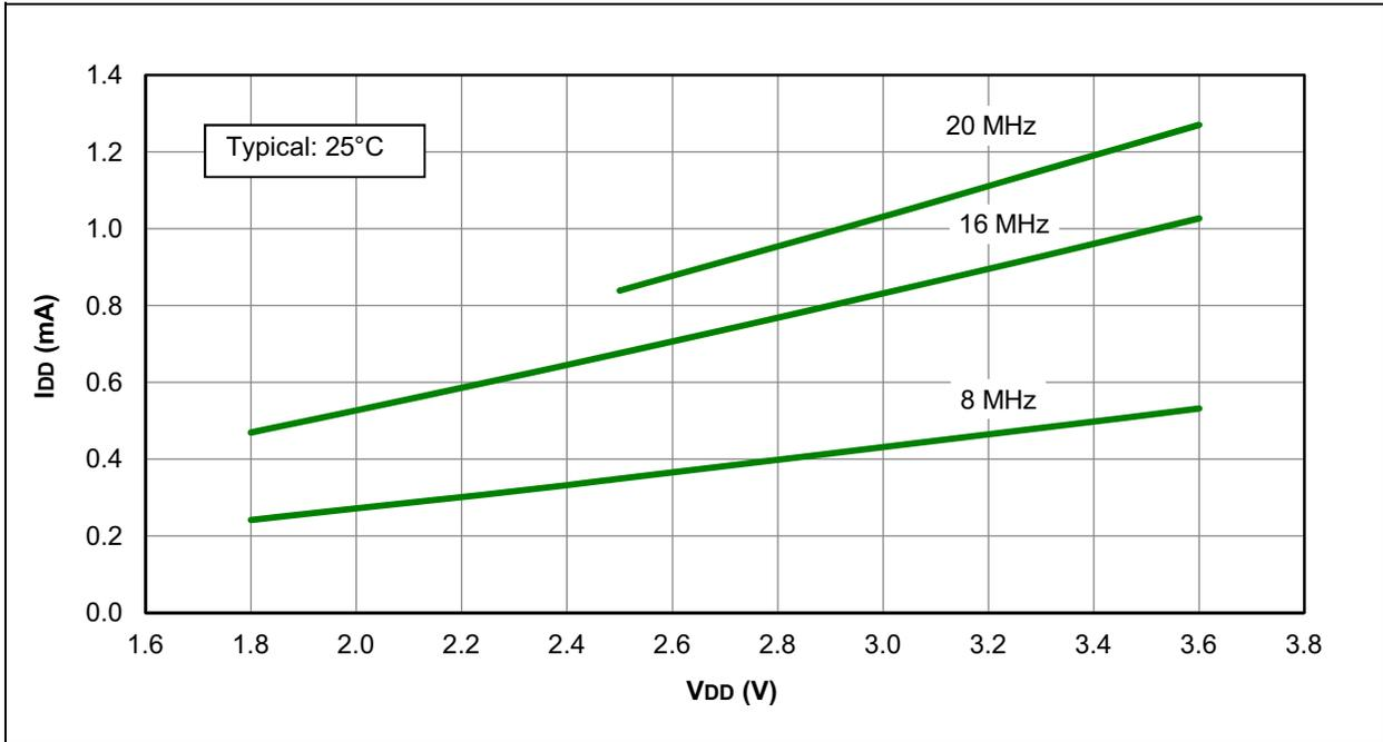
**FIGURE 28-10: I<sub>DD</sub> MAXIMUM, EXTERNAL CLOCK (ECH), HIGH-POWER MODE, PIC12LF1501 ONLY**
