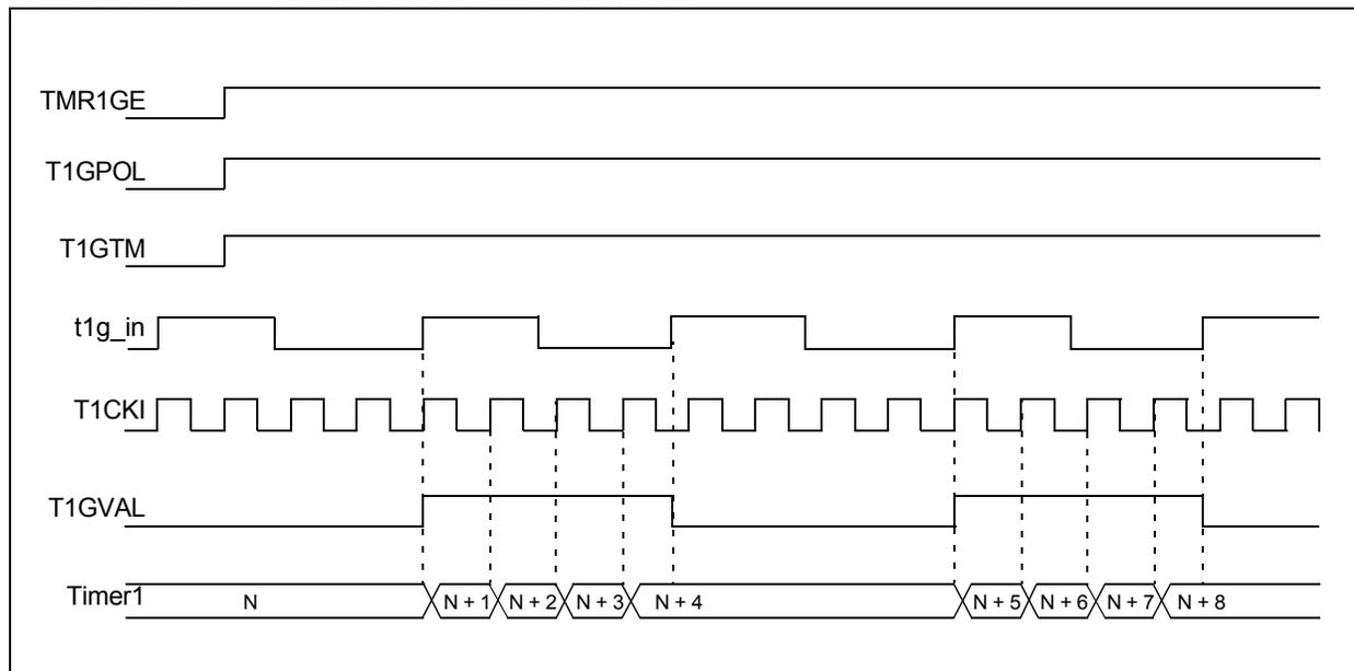
**FIGURE 19-5: TIMER1 GATE SINGLE-PULSE MODE**
