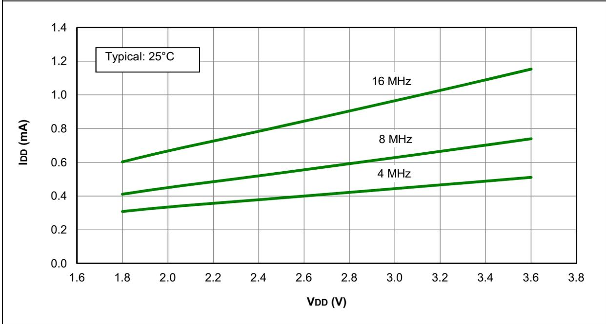
**FIGURE 28-18: I<sub>DD</sub> MAXIMUM, HFINTOSC, PIC12LF1501 ONLY**
