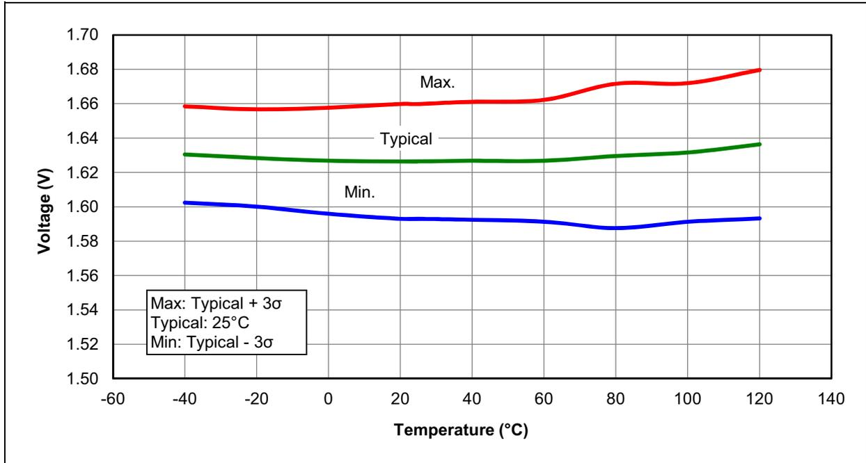
**FIGURE 28-42: POR REARM VOLTAGE, PIC12F1501 ONLY**
