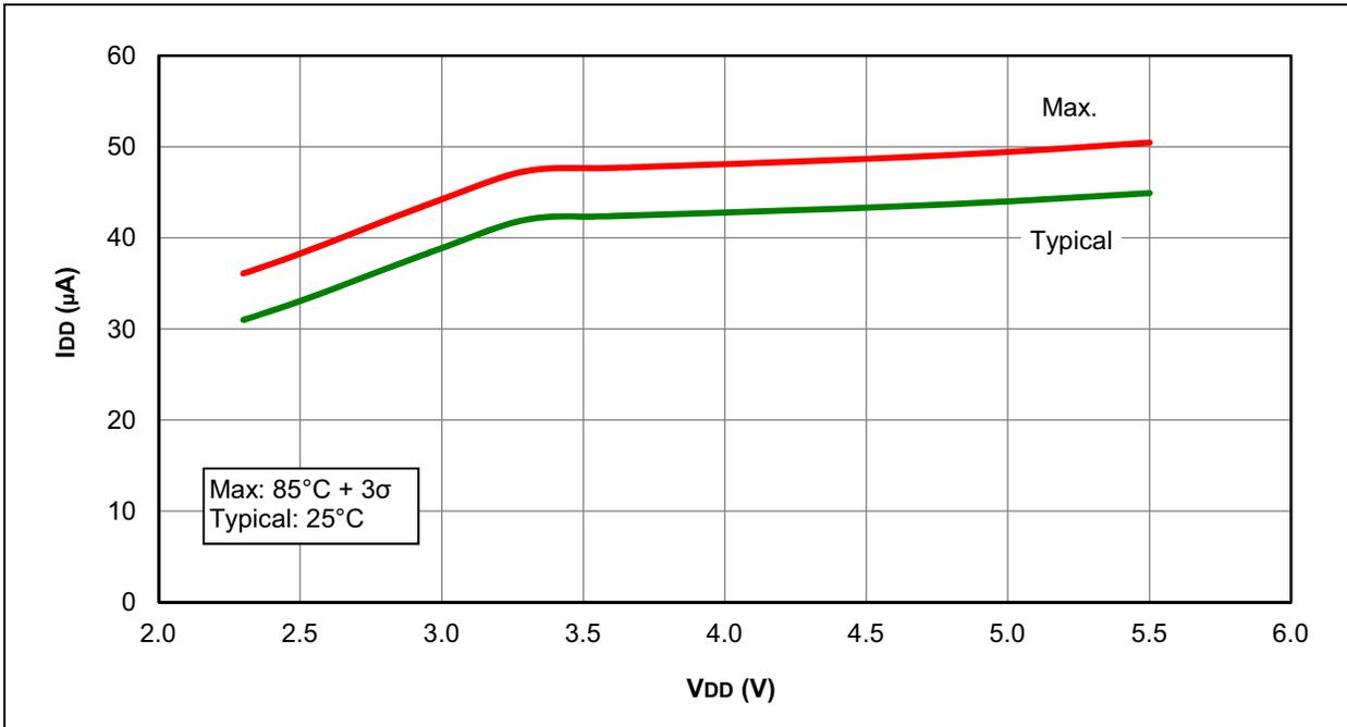
**FIGURE 28-5: I<sub>DD</sub> TYPICAL, EXTERNAL CLOCK (ECM), MEDIUM POWER MODE, PIC12LF1501 ONLY**
