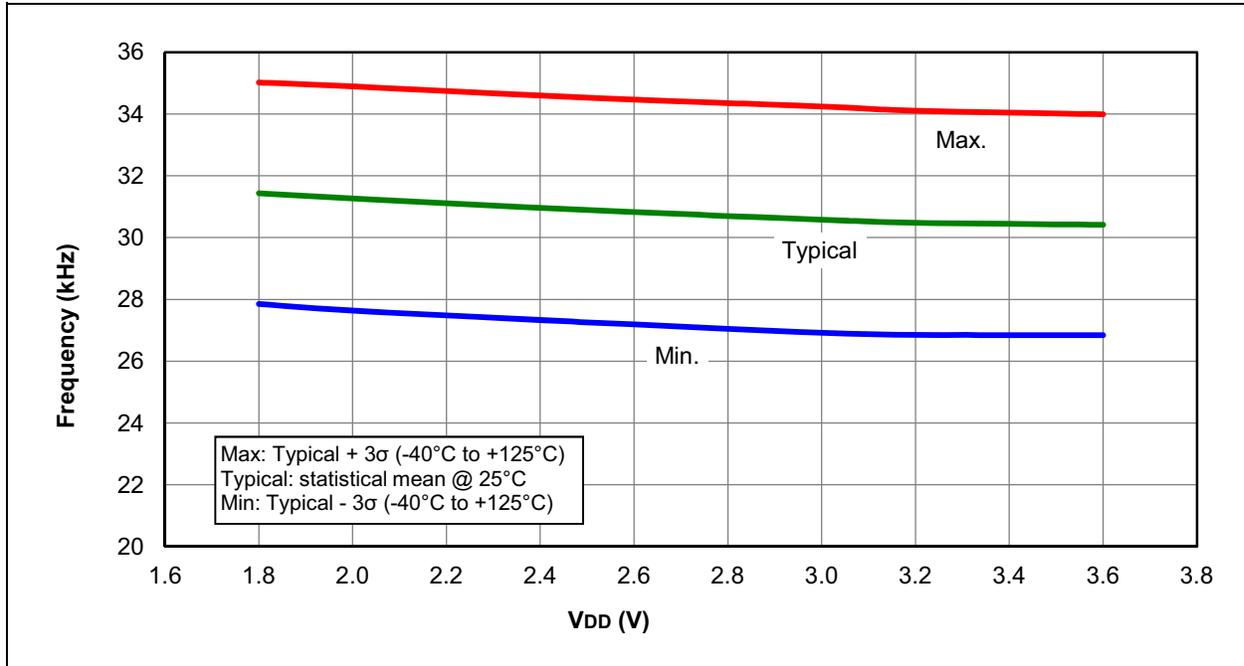
**FIGURE 28-59: LFINTOSC FREQUENCY OVER V<sub>DD</sub> AND TEMPERATURE, PIC12F1501 ONLY**
