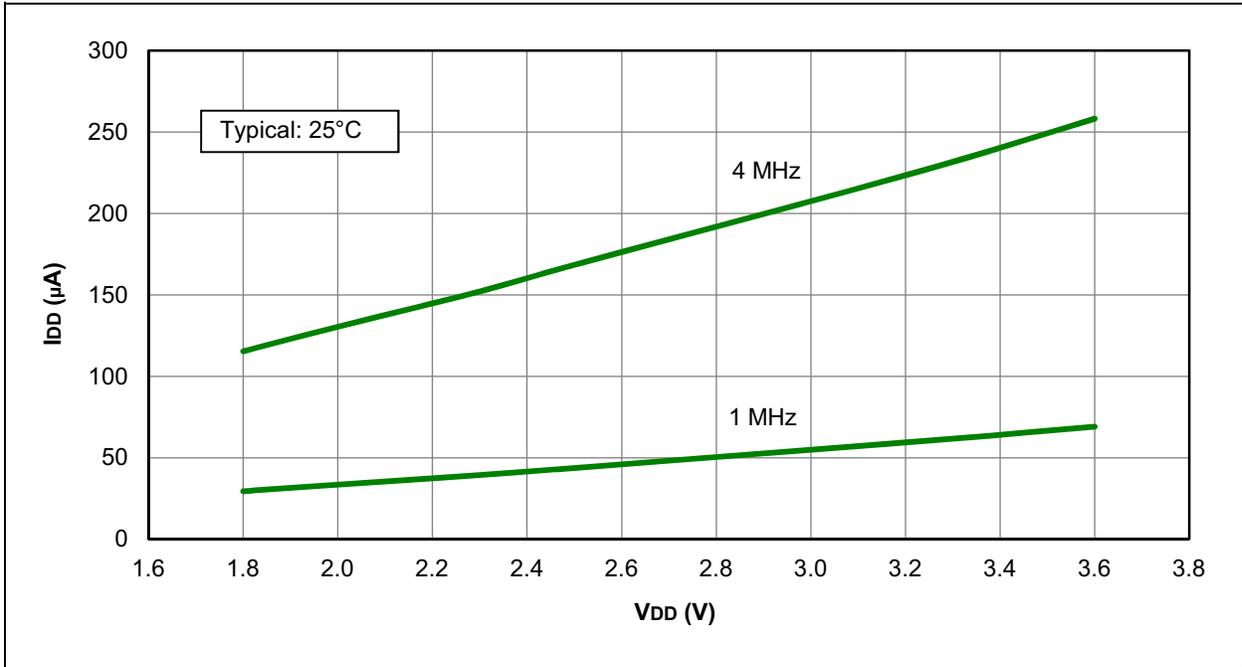
**FIGURE 28-6: I<sub>DD</sub> MAXIMUM, EXTERNAL CLOCK (ECM), MEDIUM POWER MODE, PIC12LF1501 ONLY**
