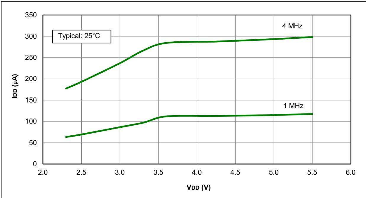
**FIGURE 28-8: I<sub>DD</sub> MAXIMUM, EXTERNAL CLOCK (ECM), MEDIUM POWER MODE, PIC12F1501 ONLY**
