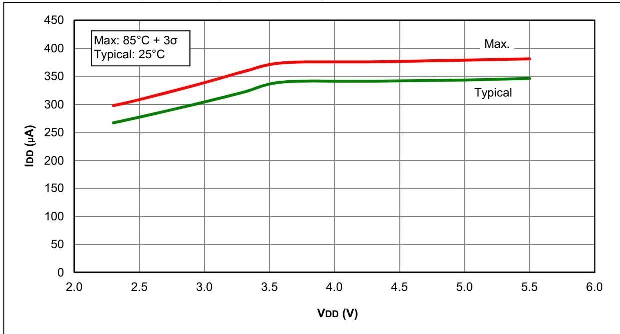
**FIGURE 28-17: I<sub>DD</sub> TYPICAL, HFINTOSC, PIC12LF1501 ONLY**
