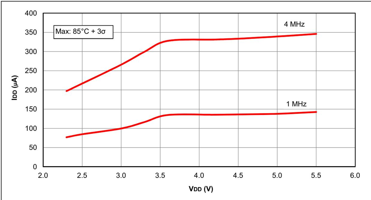
**FIGURE 28-9: I<sub>DD</sub> TYPICAL, EXTERNAL CLOCK (ECH), HIGH-POWER MODE, PIC12LF1501 ONLY**
