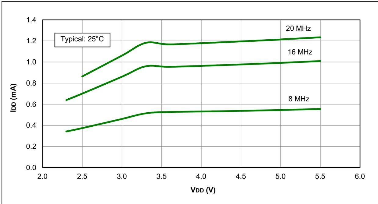
**FIGURE 28-12: I<sub>DD</sub> MAXIMUM, EXTERNAL CLOCK (ECH), HIGH-POWER MODE, PIC12F1501 ONLY**
