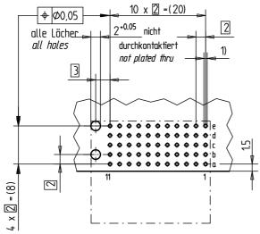
1) Ø 0.6±0.05 Durchmesser des metallisierten Loches Ø 0.6±0.05 Diameter of finished plated-through hole Ø 0.7±0.02 Bohrungsdurchmesser des Loches
