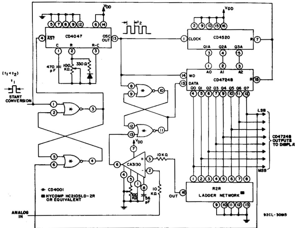
Fig. 5— A/D converter
