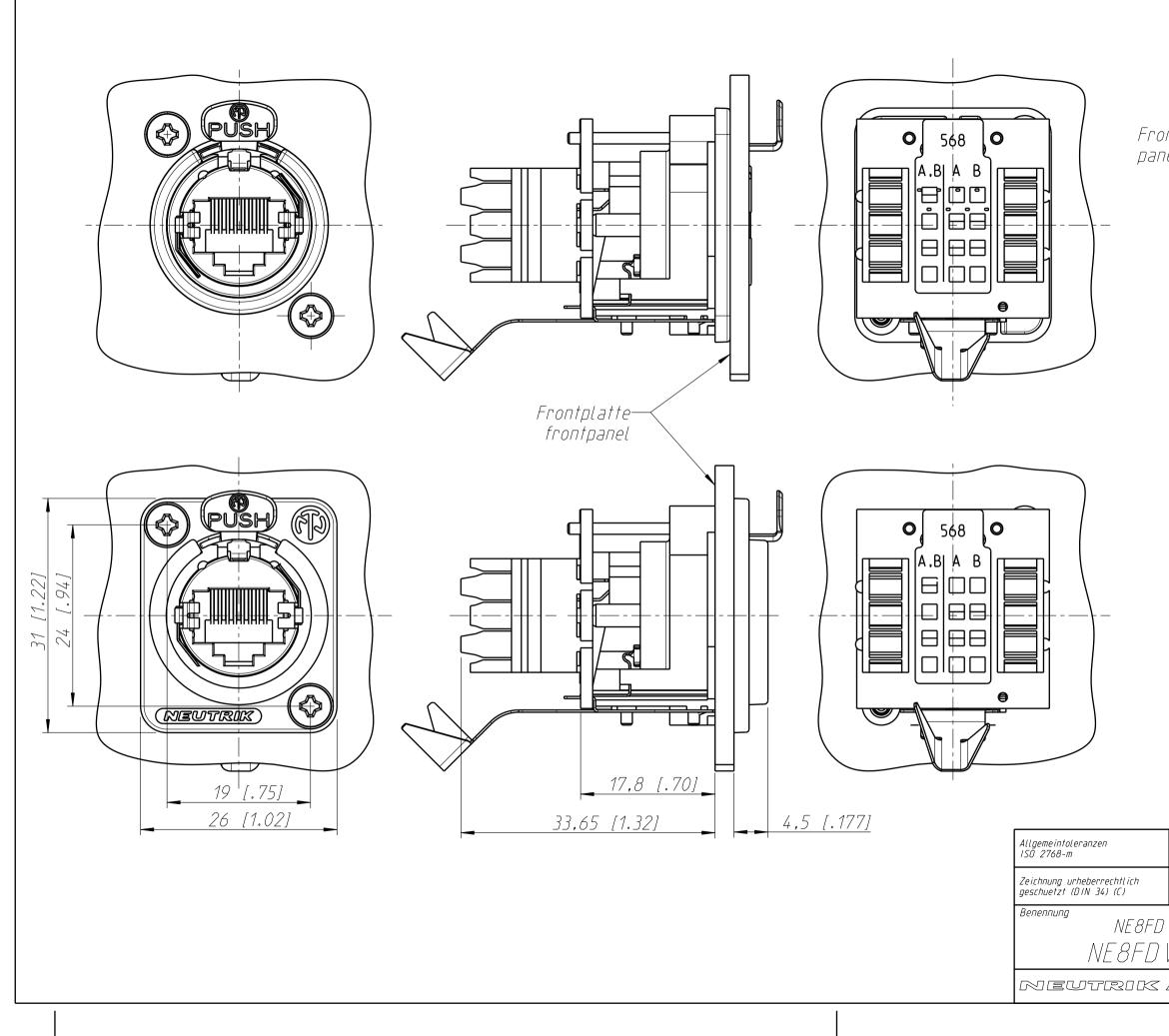
Frontplattenausschnitt (Rueckseite) panel cut out (rear side)
