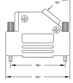
PLASTIC: ABS POLYLAC - BLACK - UL 94-HB JACKSCREWS: STEEL - BLACK HOOD SCREWS: STEEL - BLACK COMPRESSION INSERTS: ABS UL 94-HB NUTS: STEEL - BLACK OPERATING TEMP: -55°C TO +110 °C
