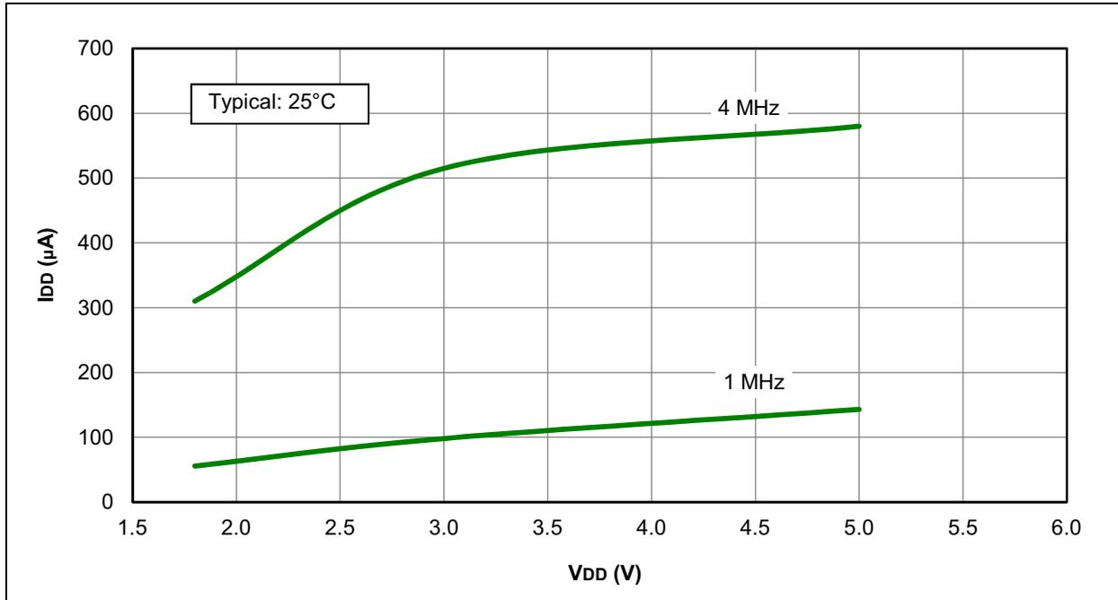
**FIGURE 31-12: I<sub>DD</sub> MAXIMUM, EC OSCILLATOR, MEDIUM-POWER MODE, PIC16F1933 ONLY**
