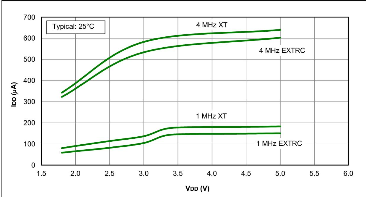
FIGURE 31-6: I<sub>DD</sub> MAXIMUM, XT AND EXTRC OSCILLATOR, PIC16F1933 ONLY
