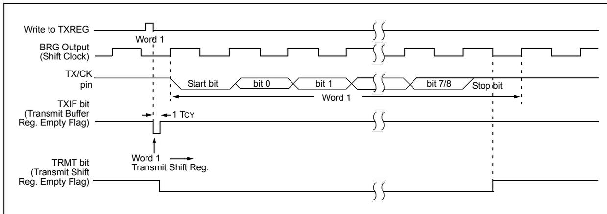
**FIGURE 25-4: ASYNCHRONOUS TRANSMISSION (BACK-TO-BACK)**
