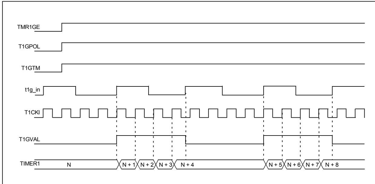
**FIGURE 21-5: TIMER1 GATE SINGLE-PULSE MODE**
