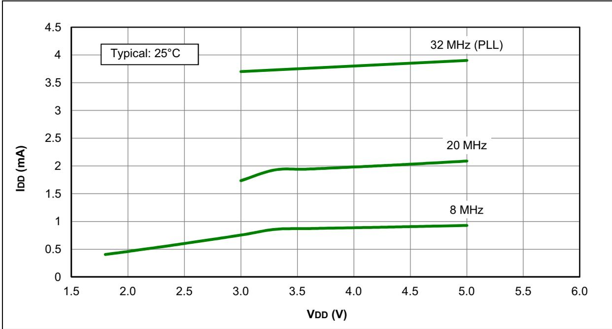
**FIGURE 31-28: I<sub>DD</sub> MAXIMUM, HS OSCILLATOR, PIC16F1933 ONLY**
