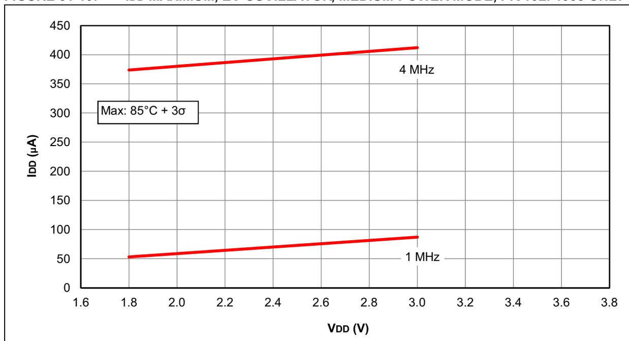
**FIGURE 31-11: I<sub>DD</sub> TYPICAL, EC OSCILLATOR, MEDIUM-POWER MODE, PIC16F1933 ONLY**
