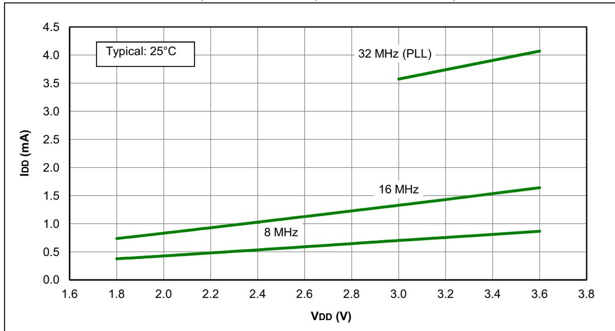
FIGURE 31-14: I<sub>DD</sub> MAXIMUM, EC OSCILLATOR, HIGH-POWER MODE, PIC16LF1933 ONLY
