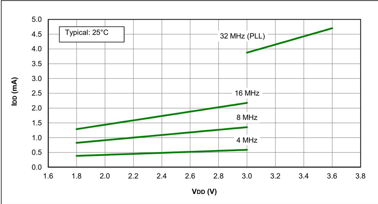
FIGURE 31-22: I<sub>DD</sub> MAXIMUM, HFINTOSC MODE, PIC16LF1933 ONLY
