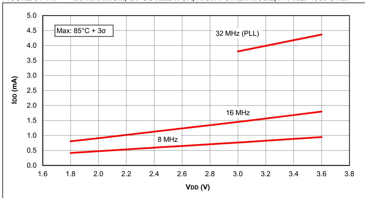
**FIGURE 31-15: I<sub>DD</sub> TYPICAL, EC OSCILLATOR, HIGH-POWER MODE, PIC16F1933 ONLY**
