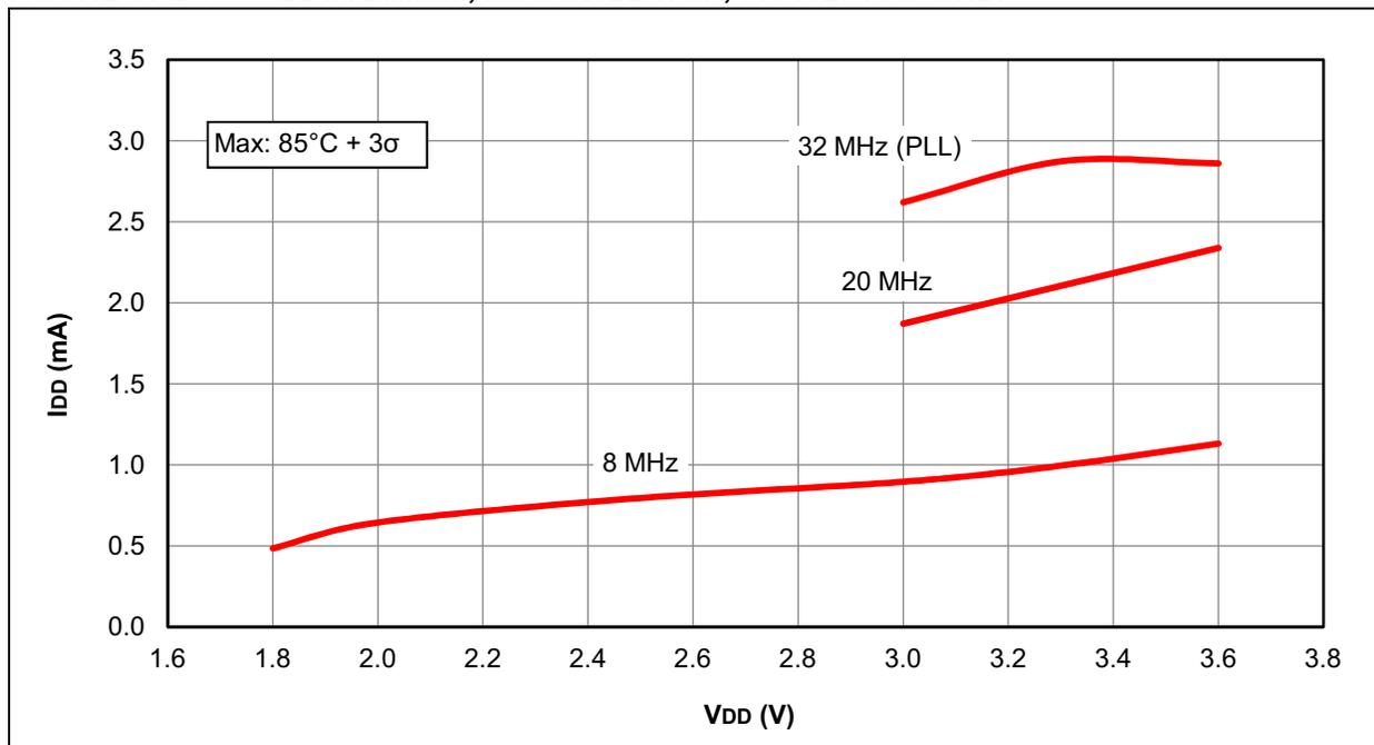
**FIGURE 31-27: I<sub>DD</sub> TYPICAL, HS OSCILLATOR, PIC16F1933 ONLY**
