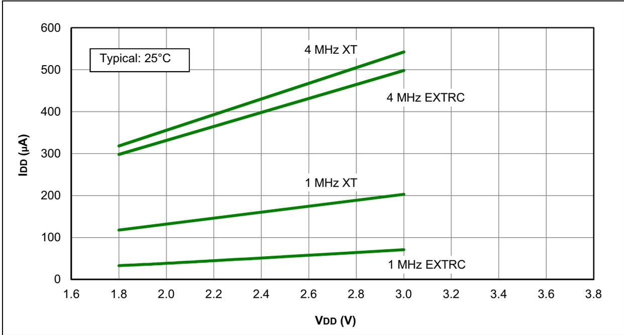
**FIGURE 31-4: I<sub>DD</sub> MAXIMUM, XT AND EXTRC OSCILLATOR, PIC16LF1933 ONLY**
