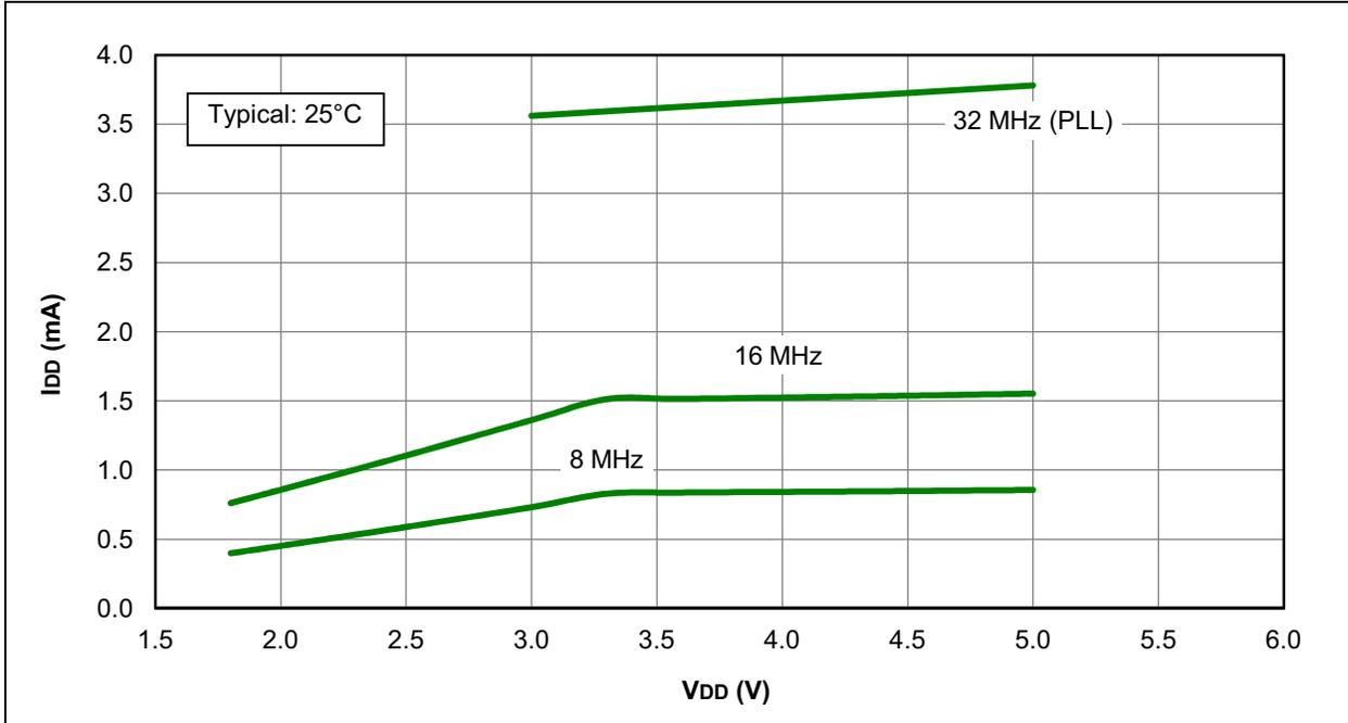
**FIGURE 31-16: I<sub>DD</sub> MAXIMUM, EC OSCILLATOR, HIGH-POWER MODE, PIC16F1933 ONLY**
