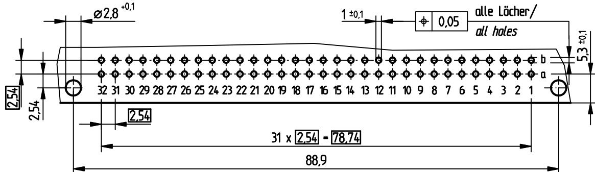
Tauchlötanschluß 0,3 x 0,7 mm / solder terminal 0,3 x 0,7 mm
