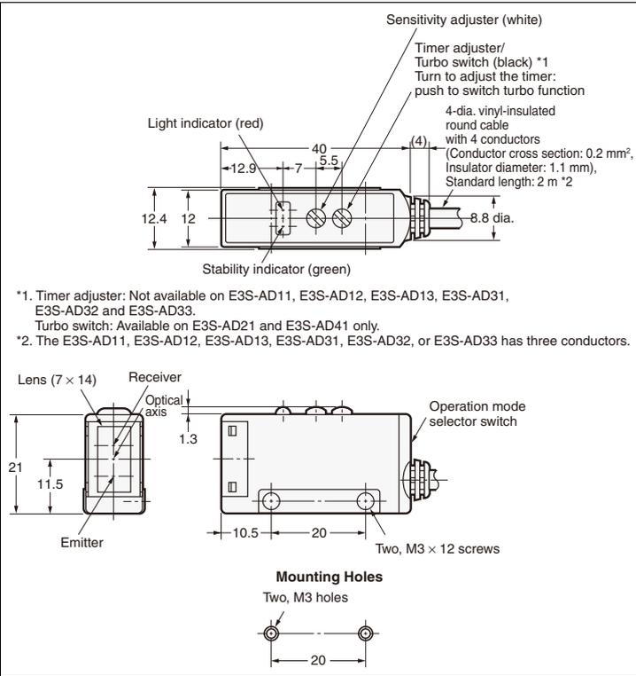
\*1. Timer adjuster: Not available on E3S-AD11, E3S-AD12, E3S-AD13, E3S-AD31, E3S-AD32 and E3S-AD33.
