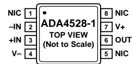
图1. ADA4528-1引脚配置(8引脚MSOP)
