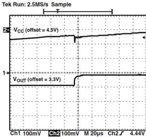
Figure 19.  $V_{CC}$  Power Up
