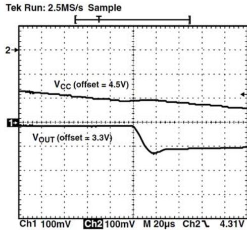
Figure 20.  $V_{CC}$  Power Down
