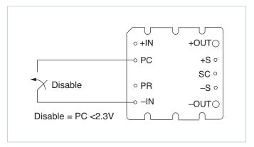
Figure 2 — Module enable/disable
