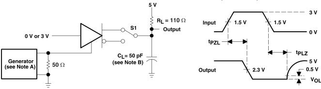
TEST CIRCUIT VOLTAGE WAVEFORMS
