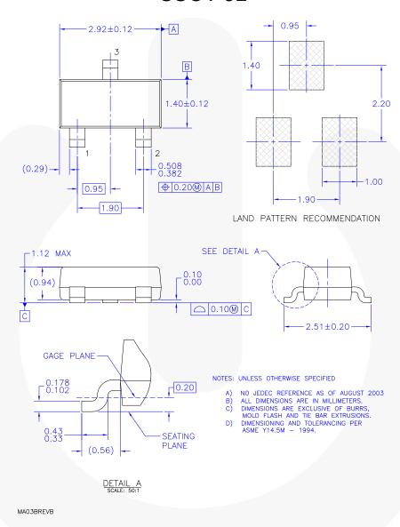
Figure 1. MOLDED PACKAGE, SUPERSOT, 3-LEAD (ACTIVE)
