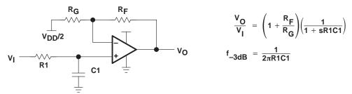
Figure 26. Single-Pole Low-Pass Filter
