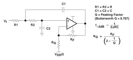
Figure 27. 2-Pole Low-Pass Sallen-Key Filter
