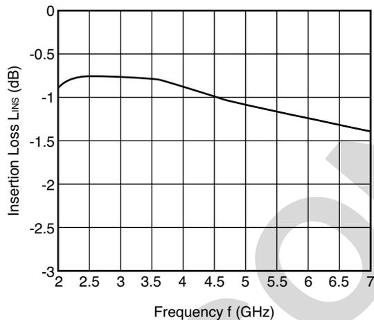
**ANT2-RX INSERTION LOSS vs. FREQUENCY**
