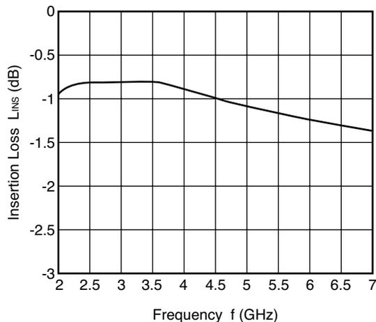
**ANT1-RX INSERTION LOSS vs. FREQUENCY**
