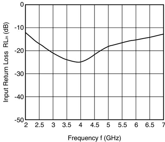
ANT2-RX OUTPUT RETURN LOSS vs. FREQUENCY
