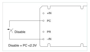
Figure 2 — Module enable/disable
